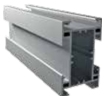
Hliníkový profil pre samonosné konštrukcie 80 x 50 mm (podperné body každých 120 cm)
