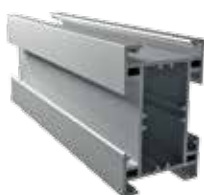
Hliníkový profil pre samonosné konštrukcie 80 × 50 mm (podperné body každých 120 cm)
